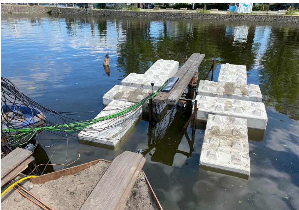
Figuur 4-2 Proef 2 met boven belasting in de vorm van legioblocks
