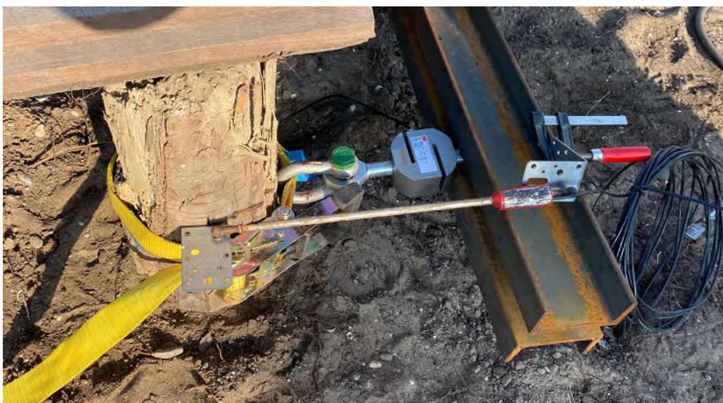
Figuur 4-1 principe van de bevestigingsconstructie tussen het stalen frame en de paal
