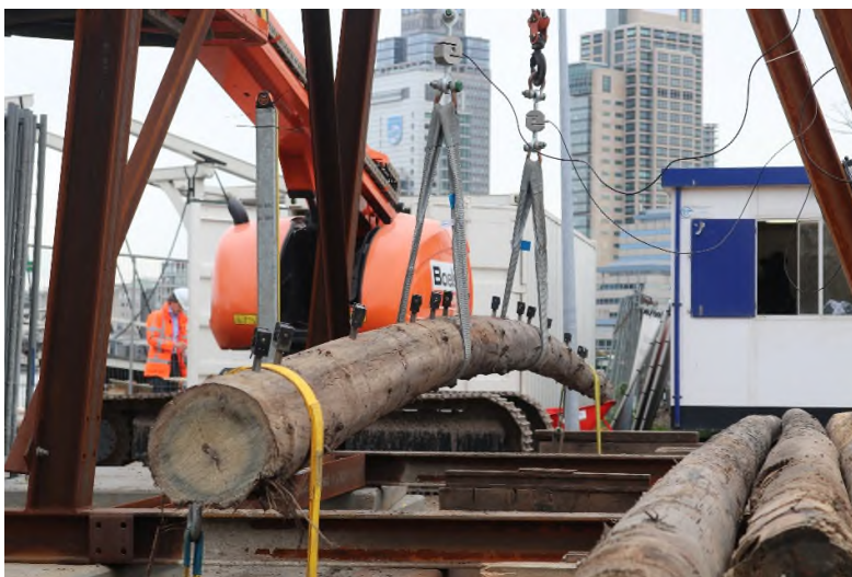
Figuur 3-1 opstelling buigproef
